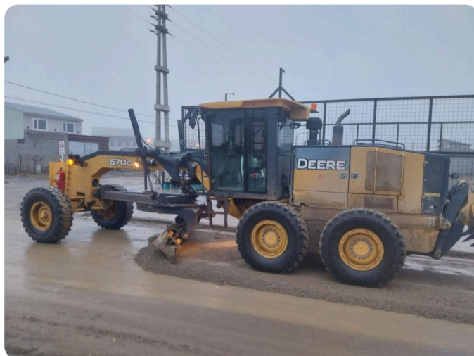
MOTONIVELADORA EN OBRA
