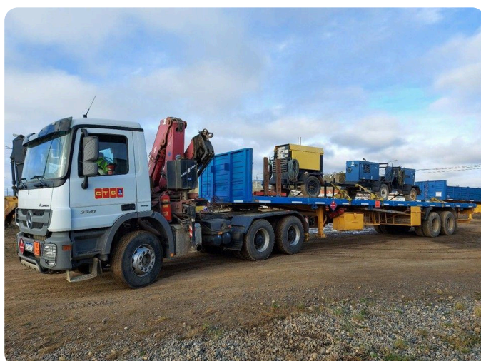
HIDROGRÚA CON SEMIRREMOLQUE
